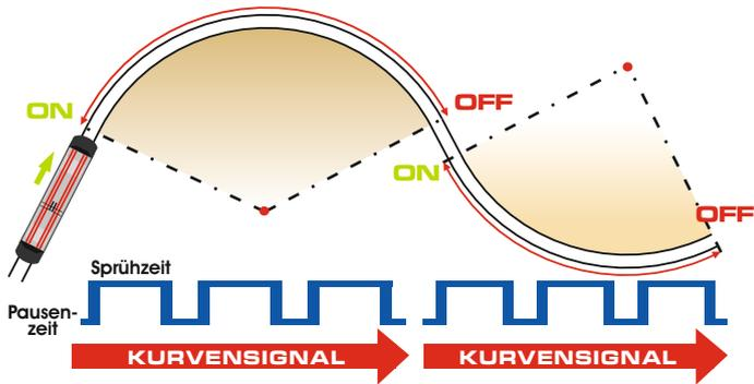
Die FluiLub Spurkranzschmierung ist als Einleitungssystem konzipiert. Das bedeutet: Wenig Verschleiß, geringer Wartungsaufwand und somit niedrige Life Cycle Costs.
