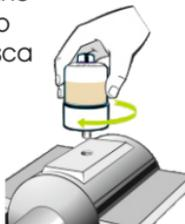
5. Apretar la conexión de la rosca de conexión mediante el hexágono
