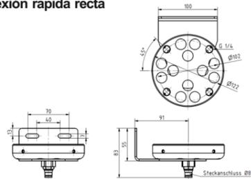
**Membrana para orificio de desaireación**
