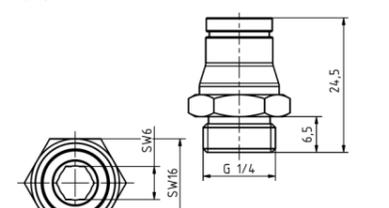
Adaptador + boquilla de lubricación
